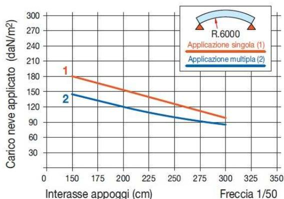
(2) Soluzione multipla con luce > 2 m. e interasse appoggi da 200 a 300, abbinamento lastra con Montante Quadro.
