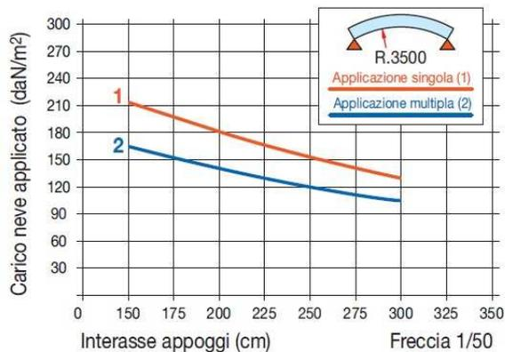
(2) Soluzione multipla con luce > 2 m. e interasse appoggi da 200 a 300, abbinamento lastra con Montante Quadro.
