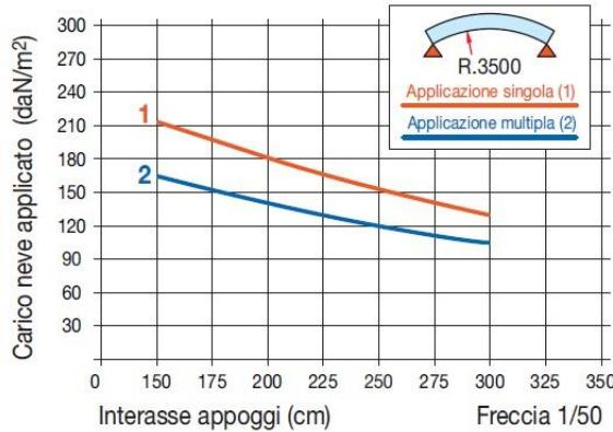
(2) Soluzione multipla con luce > 2 m. e interasse appoggi da 200 a 300, abbinamento lastra con Montante Quadro.
